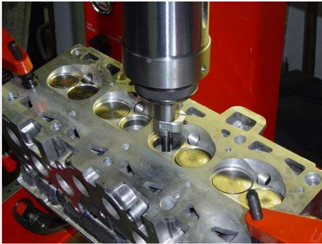
Автоматизированный процесс притирки клапанов на станке.
