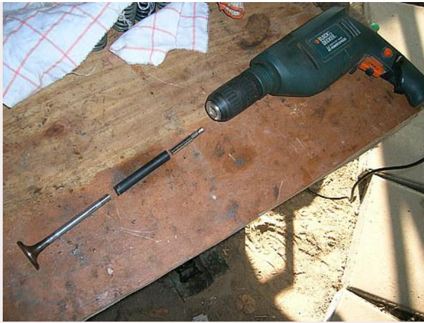
Минимально-необходимый инструмент для притирки клапанов дрелью
