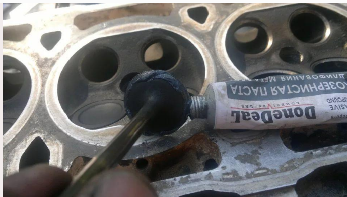
Притирка клапанов осуществляется с использованием различных абразивных паст
